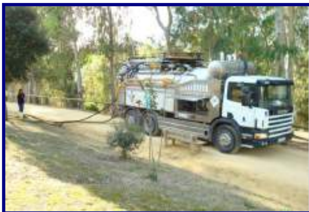
Camión de limpieza de saneamiento
