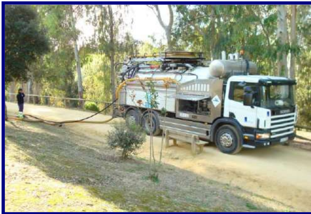
Camión de limpieza de alcantarillado
